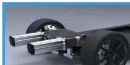
纵梁 Longitudinal Beam
